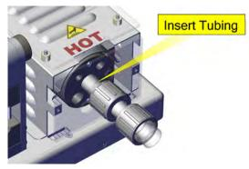
Fig. 6. Insert Tubing
